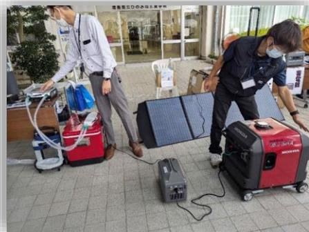
ガソリン駆動の発電機から、蓄電池を挟んで人工呼吸器へ。発電機は外部電源の充電用です。
